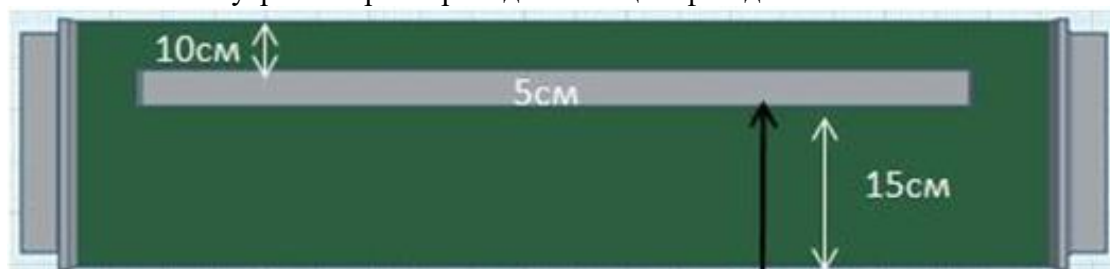
Рис. 6 Внутренние размеры одной секции фасадной панели «Лиана»
