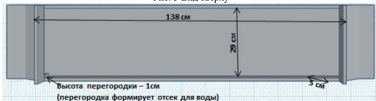
Рис. 6 Внутренние размеры одной секции фасадной панели «Лиана»
