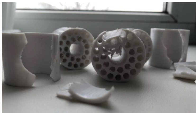
Рис. 5. Образцы после воздействия ударной нагрузки
