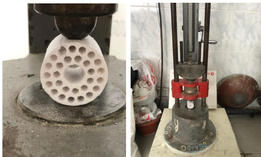
Рис. 4. Испытания на копёре свободного падения
